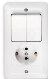
2В-РЦ-649 (6А) Двухклавишный выключатель + розетка с з/к, Размер блока: 158x80x52 мм коробки : 123x70x30 мм
