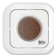
C1-100-033 (100 Вт) C1-230-039 с лапками (230 Вт) Выключатель (таймер) сенсорный с задержкой времени отключения 80x80x46 мм - скрытая установка 80x80x55,4 мм - открытая установка
